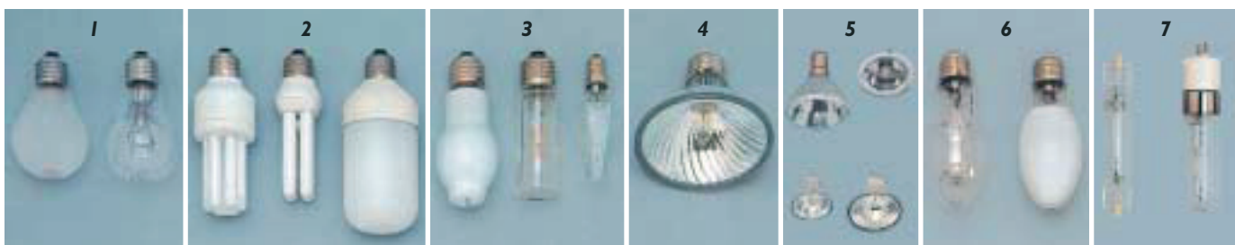
Alle Lampen (Glühbirnen 1, Kompaktleuchtstofflampen 2, Halogen-Glühlampen 3, Pressglasreflektor-Halogen-Glühlampen 4, Niedervolt-Halogen-Glühlampen 5, Halogen-Metallampflampen 6, Natriumdampf-Hochdrucklampen 7) haben ihre Vor- und Nachteile. Energieeffizienz, Lebensdauer, Lichtfarbe usw. müssen bei der Entscheidung berücksichtigt werden. (Bilder FGL)
